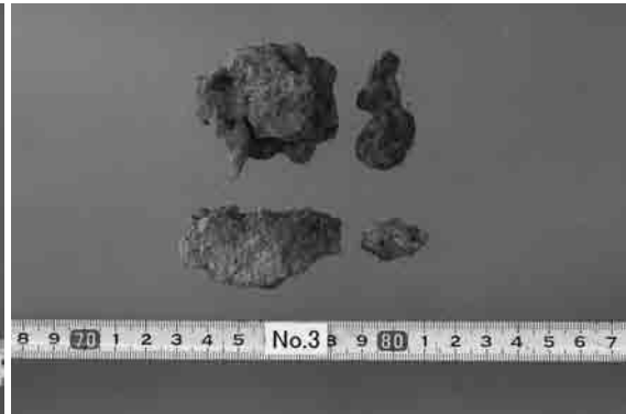
外観写真 No.3 (炉底滓)
