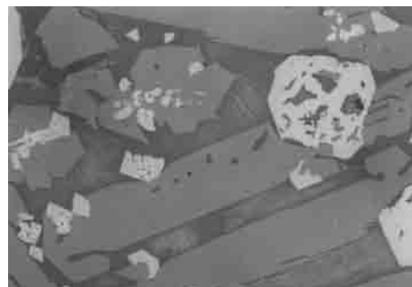
顕微鏡組織写真 No. 2-1 (椀形滓)
