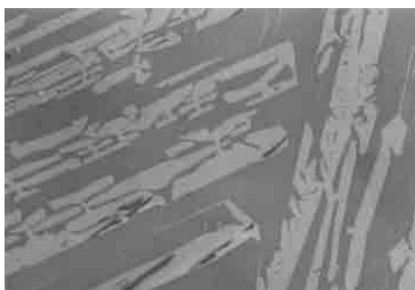
顕微鏡組織写真 No. 5-2 (鉄滓2)
