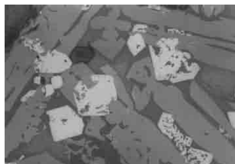
顕微鏡組織写真 No. 2-2 (椀形滓)
