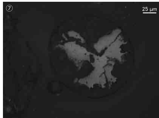
photo.7 銅塊(MMY-4)の顕微鏡組織
