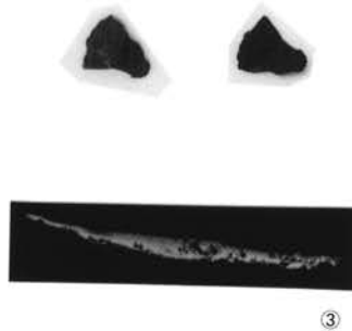
URI-8-5 鍛造剥片 ③×20 マクロ組織 ④×400 no etch ⑤×100 ⑥×400 王水etch 3層分離型 内層ヴスタイト非晶質
